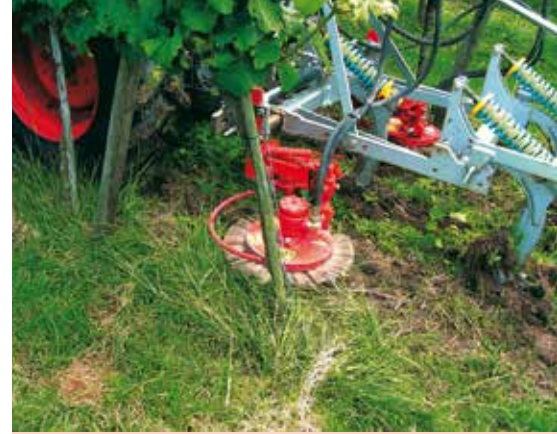
INTERPLANET Fräskopf am Grubber
