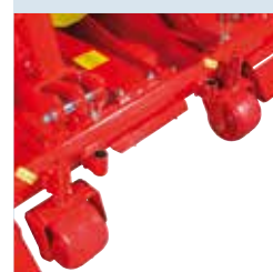
Laufräder mit Positionswechsel bei SHF 215.
