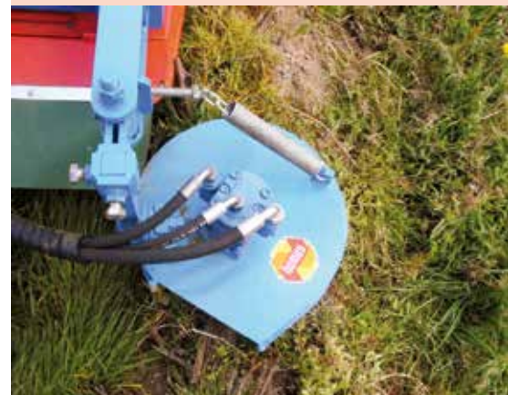
INTERPLANET Mulchkopf am Kreiselmulcher LV
