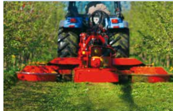
Mulchen auf gesamter Arbeitsbreite (z.B. im Vorgewende)
