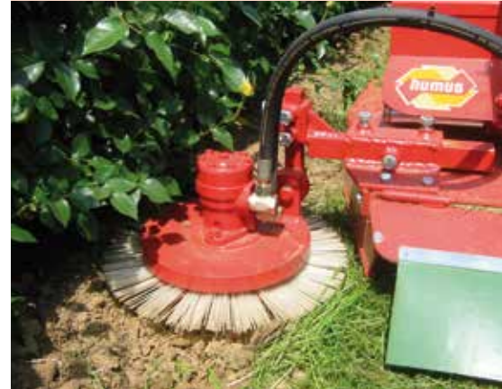
INTERPLANET Fräskopf am Kreiselmulcher LV
