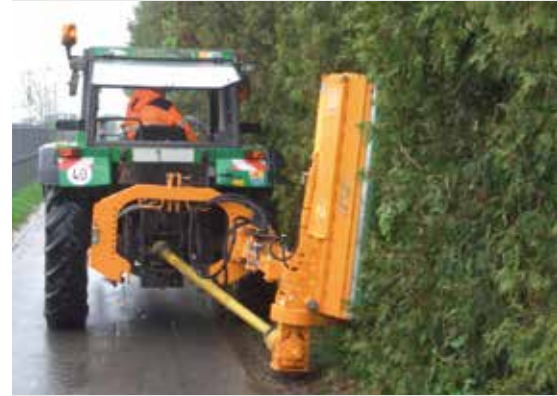
Stufenlos variierbarer Neigungsbereich des Mähkopfes von 90° nach oben und 60° nach unten.
