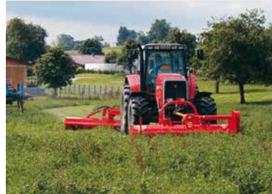
Attraktive Leistung im Großflächeneinsatz: In Kombination mit einem Frontmulcher wird eine Gesamtarbeitsbreite von bis zu 5,40 m erreicht.
