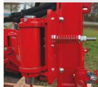
Die stabile Anfahrtsicherung sorgt für größtmöglichen Schutz bei Kollisionen mit Hindernissen.
