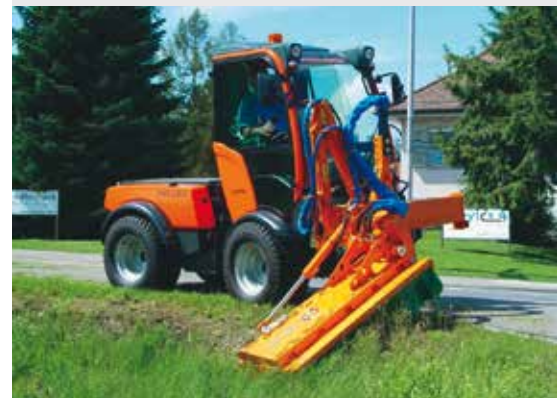
Stufenlos variierbarer Neigungsbereich des Mähkopfes nach oben 90° und nach unten 60°
