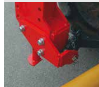
Kat. II zum Demontieren sorgt für größeren Freiraum der Gelenkwelle.
