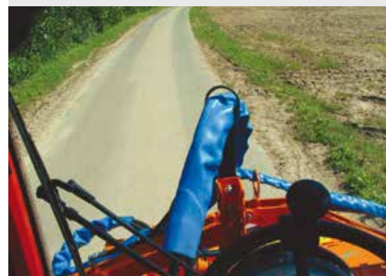
Über die neu entwickelte Seitenverschiebung wird der Seitenmulcher direkt vor dem Trägerfahrzeug positioniert. So entsteht keine Sichtbehinderung im Straßenverkehr/-transport.
