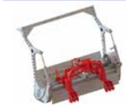
Dreipunktaufnahme* Kat. II Hydraul. Seitenverstellung in Verbindung mit Parallelogrammverstellung, Verstellweg ca. 40 cm
