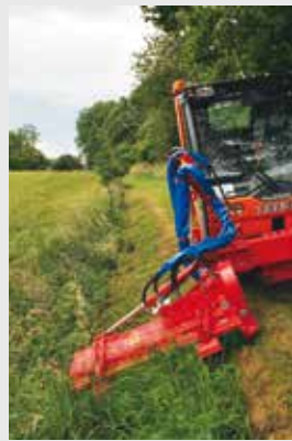
Stufenlos variierbarer Neigungsbereich des Mähkopfes nach oben 90° und nach unten 60°
