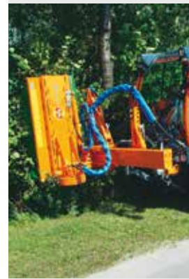
Stufenlos variierbarer Neigungsbereich des Mähkopfes nach oben 90° und nach unten 60°
