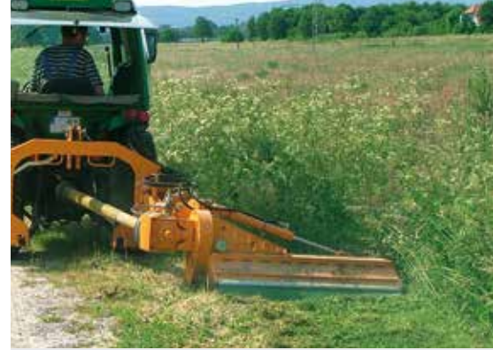
Stufenlos variierbarer Neigungsbereich des Mähkopfes von 90° nach oben und 60° nach unten.
