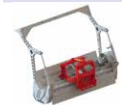
Robocut-Anbau mit Drehlager und mechanischen Oberlenker oder mit Drehlager und hydraulischen Oberlenker
