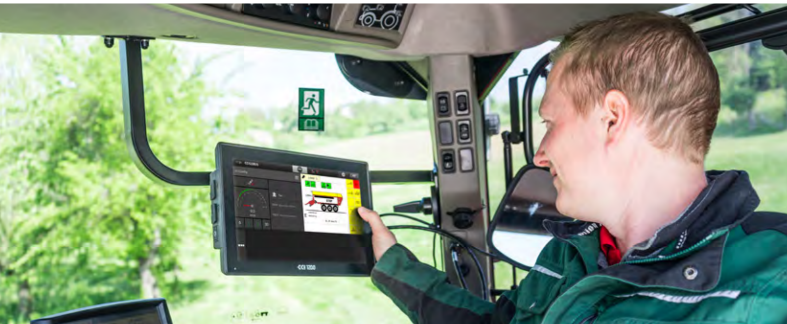
CCI 1200 – ein Terminal für jede ISOBUS-fähige Maschine. Das große Display und die flexible Anordnung von Maschinen, Kamera und Section Control machen die ganze Saison Spaß.
