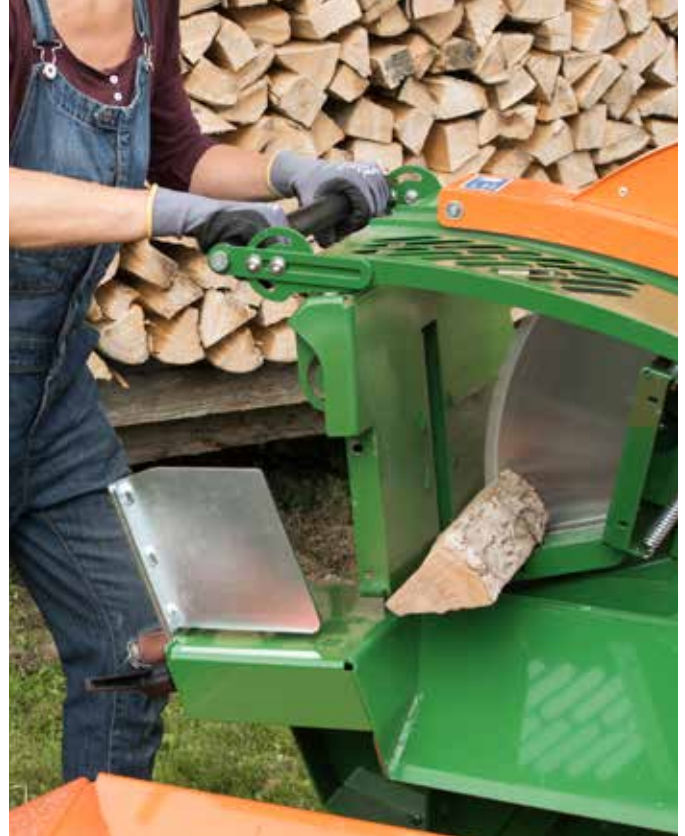
Die Sicherheitsklappe mit ergonomischer Höhenverstellung: Der Gefahrenbereich ist abgedeckt.
